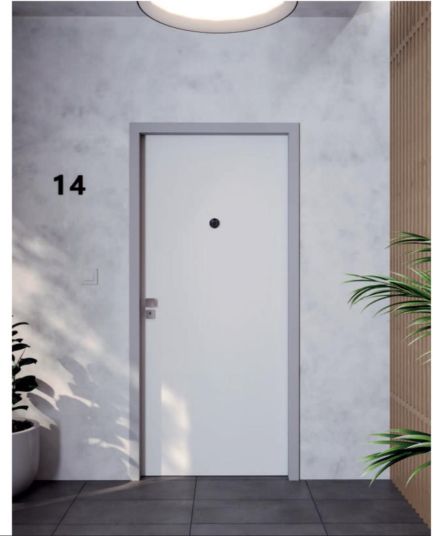
**pohled z chodby:** Provedení ELEGANT 10 - HPL Antifinger prémiově bílá W1000, kovová zárubeň SAP 865 - RAL 7035, protipožární odolnost 45 min, bezpečnostní třída RC3, zvukový útlum 37 dB a odolnost klima III, bezpečnostní kování M9, digitální kukátko Eques S1 Pro
