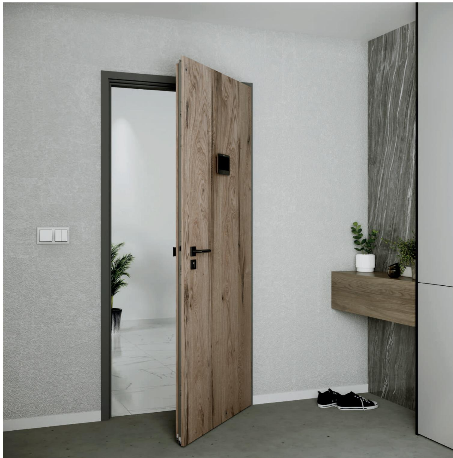
**pohled z bytu:** Provedení ELEGANT 10 - dýha Dub trámový, olej Super White, záruční SAP 871 - RAL 7024, protipožární odolnost 30 min, bezpečnostní třída RC3, zvukový útlum 43 dB a odolnost klima III, bezpečnostní kování M9, digitální kukátko Eques S1 Pro
