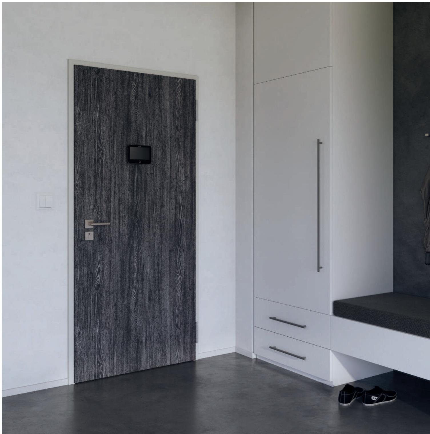
**pohled z bytu:** Provedení ELEGANT 10 - HPL Feel Nature dub Halifax lazurovaný černý, kovová zárubeň SAP 865 - RAL 7035, protipožární odolnost 45 min, bezpečnostní třída RC3, zvukový útlum 37 dB a odolnost klima III, bezpečnostní kování M9, digitální kukátko Eques S1 Pro
